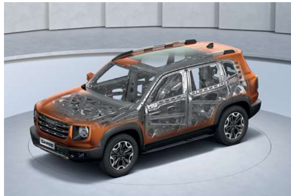
Бағдарламаланған деформациялану аймақтары
