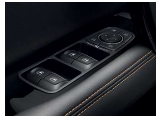
Төрт есіктің автожеткізгіші және қысудан қорғау функциясы бар электржетекті әйнеккөтергіштері
