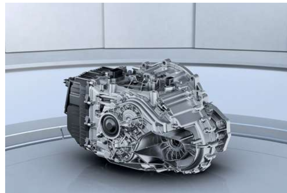
«Дымқыл» типті 7 сатылы робот беріліс қорабы
