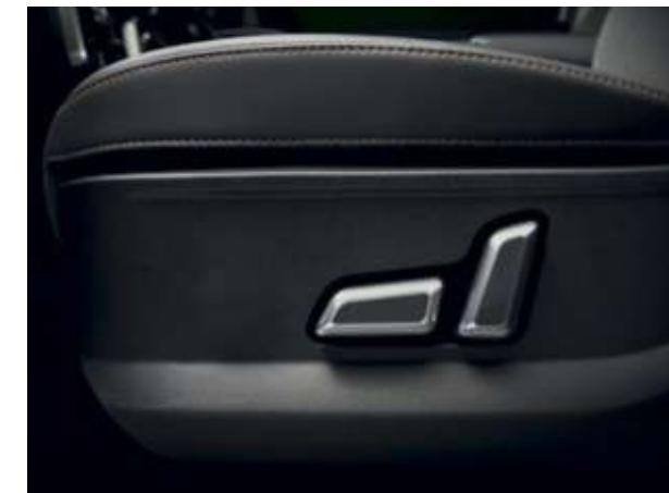
Жүргізуші орындығын 8 бағытта электр реттеу мүмкіндігі
